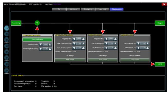
РИС. 5: Выходы общего назначения (GPO): интерфейс мониторинга системы.
